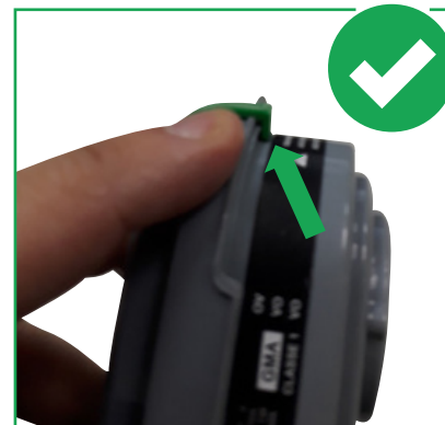
Asegurar la tapa, debe estar unida la base de arriba y abajo
